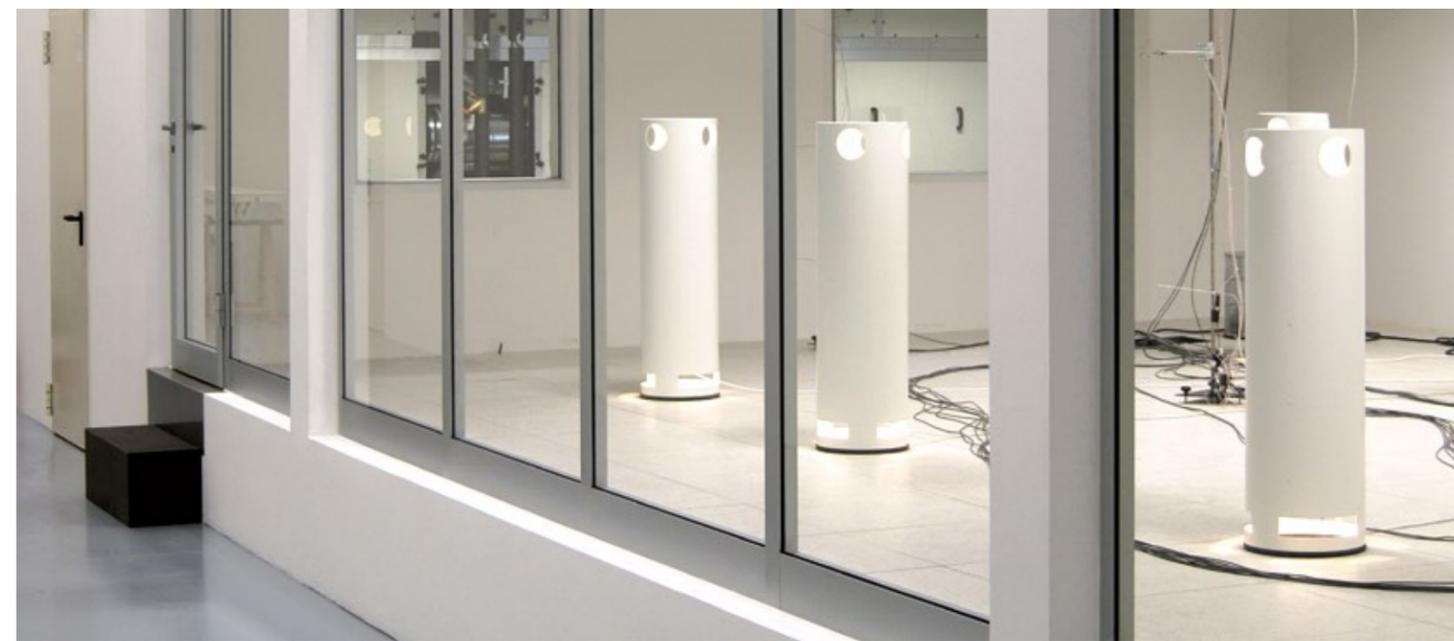
Tra le prime nel Mondo ad avere una camera climatica, realizzata secondo i criteri della norma EN15116, l'azienda dispone di una sala prove per testare le prestazioni delle unità di trattamento d'aria. Il laboratorio permette di ottenere un monitoraggio accurato di tutte le caratteristiche prestazionali per raggiungere sempre il massimo standard di prodotto.
