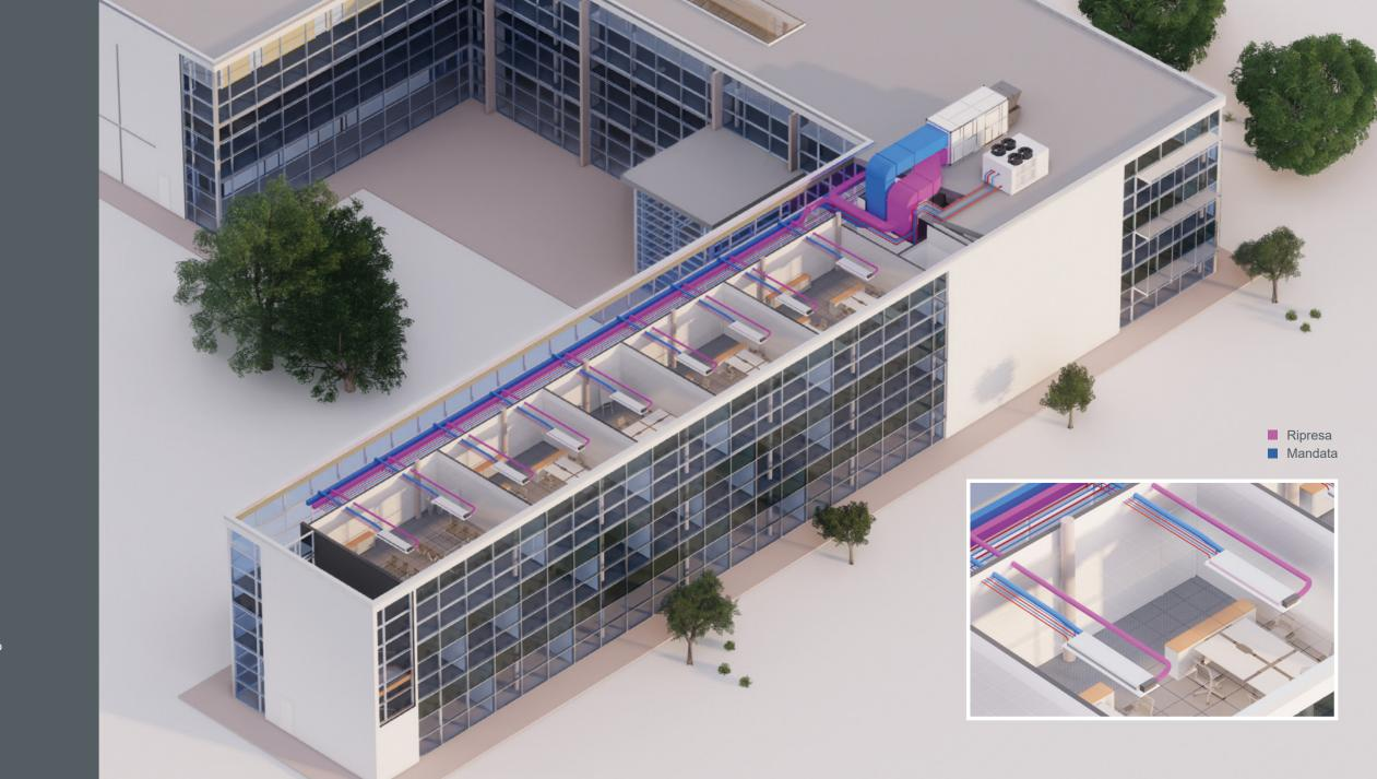
La centrale di trattamento aria è il motore dell'impianto a travi fredde, provvede al rinnovo dell'aria negli ambienti garantendo i corretti valori di umidità.
