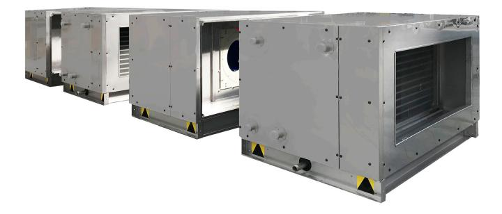
Il pannello, di tipo sandwich con spessore 90mm per il fondo delle sezioni e 54 mm per le pareti laterali e superiori, è costruito internamente in acciaio inox AISI 304 o AISI 316L ed esternamente in lamiera zincata preverniciata con materiale isolante in poliuretano espanso iniettato ad alta densità (circa 45 Kg/m³) o lana di roccia a fibre orientate (circa 90 Kg/m³).
